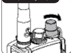
An/Aus/Lautstärkeregelung (gegen den Uhrzeigersinn)
