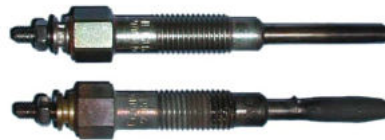
Bild 3. Oskadat glödstift (ovan) och ett skadat, kortslutet glödstift (nedan)
