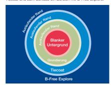
Tragen Sie die entsprechende Grundierung (Gelshield® 200 oder Interprotect®) gemäß der ursprünglichen Spezifikation für den erforderlichen Untergrundschutz auf, sodass sie die intakte Grundierung überlappt. Hinweis: Bei der Anwendung mit der Rolle können mehrere Anstriche erforderlich sein, um die gewünschte Trockenschichtdicke (TSD) zu erreichen. Beachten Sie die empfohlenen Überstreichintervalle zwischen den Anstrichen, wie sie im Produktdatenblatt der Grundierung angegeben sind.
