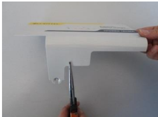
Ausbrechen der Metallzunge mit einer Flachzange
