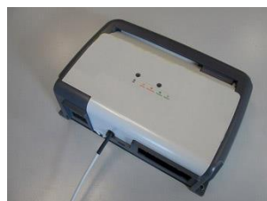
Einsetzen der Abdeckung und der Leitung.
