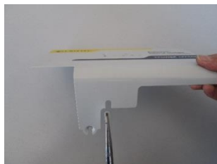
Ausbrechen der Metallzunge mit einer Flachzange
