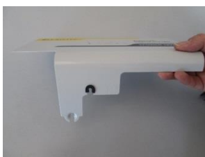
Einsetzen der Abdeckung und der Leitung.
