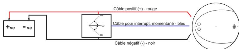
**Note:** les modalités de réglage de l'intensité lumineuse au moyen d'un interrupteur externe diffèrent de la gestion par commande tactile puisque l'intensité lumineuse sera ramenée automatiquement à un niveau commun dès lors que l'interrupteur est activé pendant plus de 3 secondes. Ceci permet à plusieurs lampes d'être contrôlées et synchronisées à partir d'un ou plusieurs interrupteurs externes.
