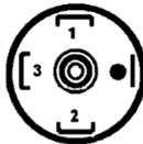
Pin 1 muss über die beiliegende Sicherung an die Plus – Versorgungsspannung angeschlossen werden, Pin 2 an den entsprechenden Tank-Eingang Tx des TCM4V / CMT2.
