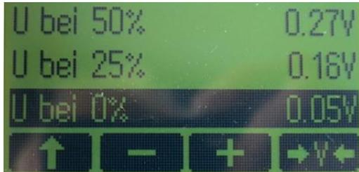
Für die Füllstände 25, 50, 75 und 100% müssen die entsprechenden Spannungswerte eingegeben bzw. messtechnisch ermittelt werden.
